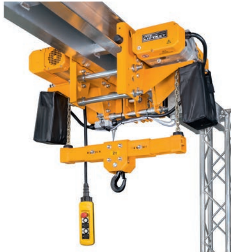
Примеры системы STAR LIFTKET с минимальной строительной высотой может использоваться в качестве стационарной тали или с тележкой ручного или электрического управления. (Специальное исполнение с перемещением по зубчатой рейке).
