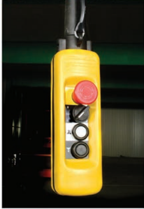
Пульт управления спереключателем для управления двумя электрическими таями.
