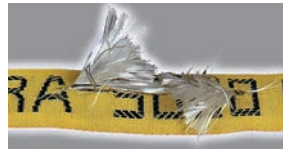
Повреждение внутренних прядей
