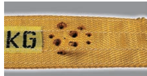
Повреждение в результате воздействия высокой температуры
