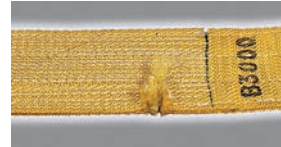
Повреждение основного шва
