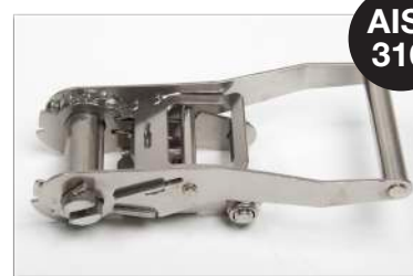
Код изделия SVKI2000AIS LC 1500 кг, текстильная стропа шириной 50 мм Нержавеющая сталь AISI 316
